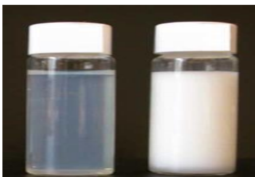
Figura 6 – Nanoemulsão (à esquerda) versus emulsão convencional (à direita) com diâmetros das gotículas de 35 nm e 1 \mu m, respectivamente.
