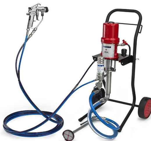
Figura 5 – Equipamentos de Pintura industrial: exemplo de Pistola sem Ar. Fonte: Mairless, Equipamentos de Pintura, 2015.
