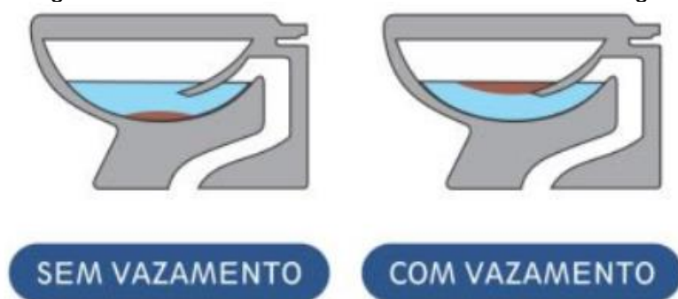
Figura 23: Vazamento na válvula ou caixa de descarga
