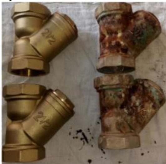
Figura 10: Conexões de bronze corroídas
