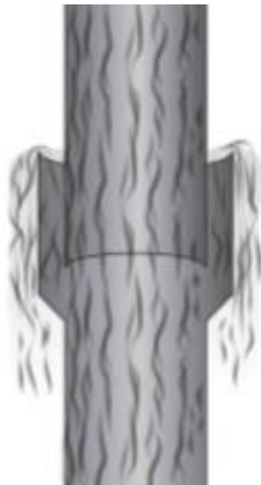
Figura 21: Vazamento na união do tubo de ponta e de bolsa
