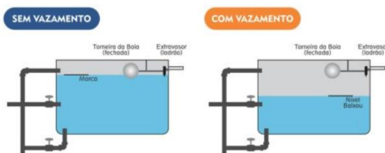
Figura 1: Vazamento em cisterna
