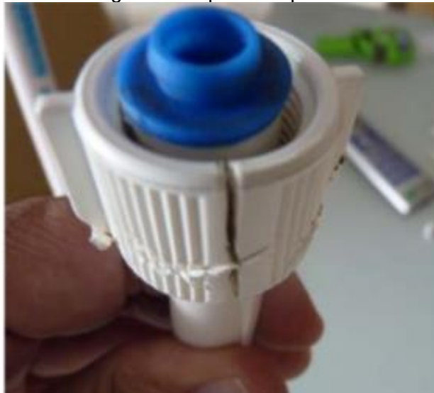
Figura 4: Ruptura de porca
