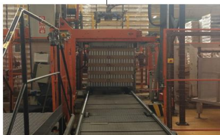
Entrada do pallet no despaletizador.
