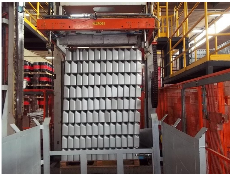
Figura 1 – Frascos desalinhados na entrada da máquina despaletizadora
