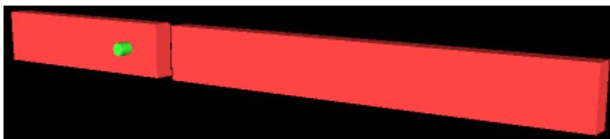
Figura 5 – Erro 34 Interferência Entre Tubulação de Água e Viga Estrutural
