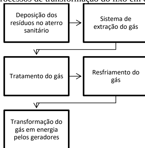
Fluxograma 1: Processos de transformação do lixo em eletricidade
