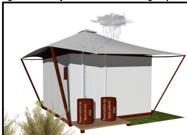
Figura 36: Projeto com coleta de água potável
