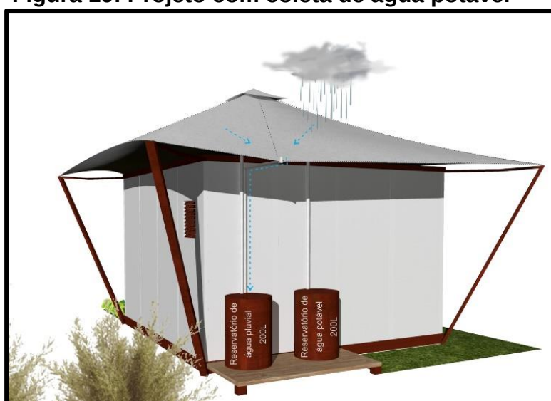
Figura 19: Projeto com coleta de água potável
