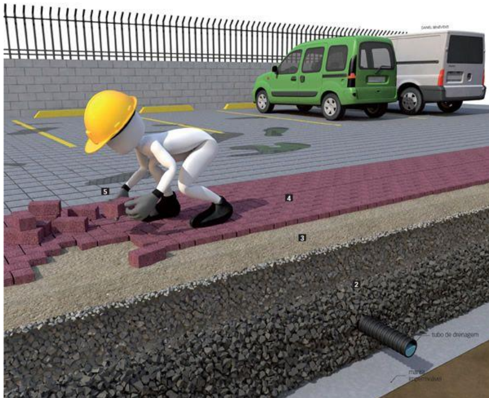
Figura 66 – Execução de pavimento permeável
