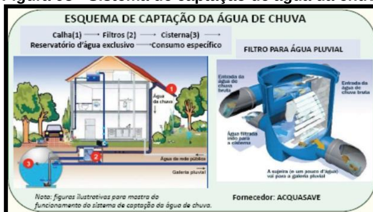
Figura 98 - Sistema de captação de água da chuva.
