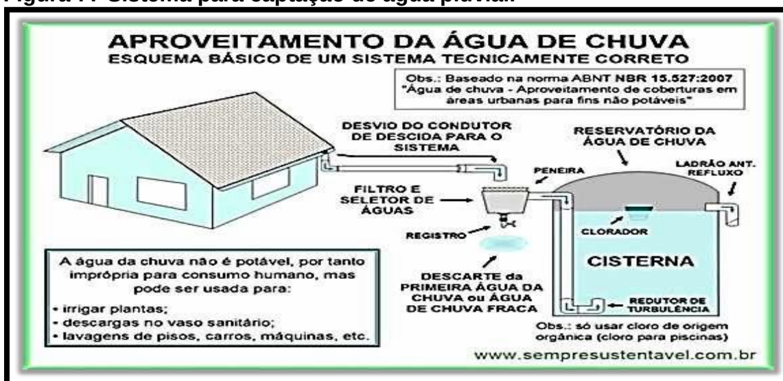
Figura 77 Sistema para captação de água pluvial.
