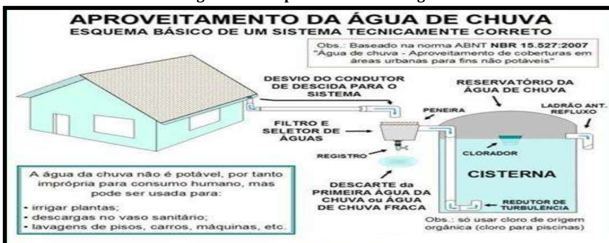
Figura 112 – Aproveitamento da água de chuva
