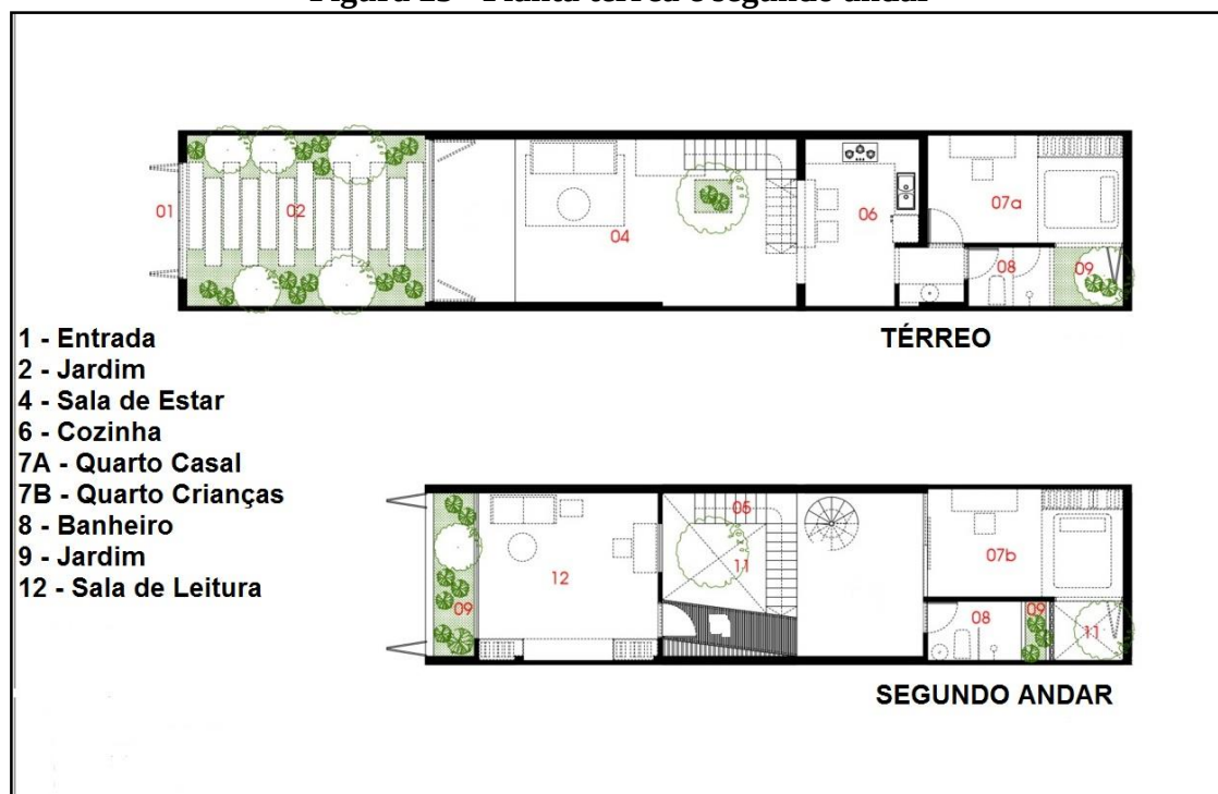
Figura 23 - Planta térrea e segundo andar
