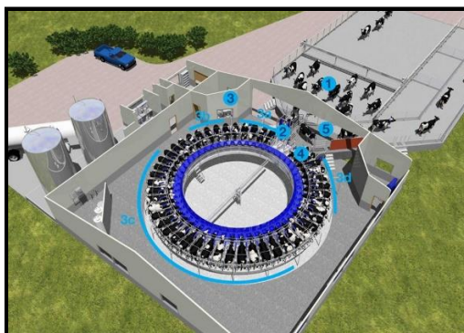
Fig. 11 – Funcionamento do sistema “carrossel”.
