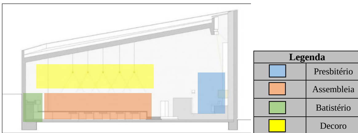
Figura 55: Corte Longitudinal (Archdaily, 2018c)
