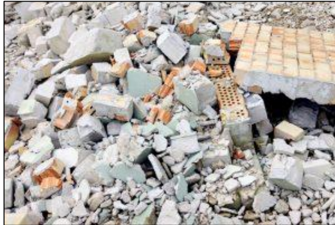
Figura 118: Entulhos são utilizados como agregados para a composição de concreto armado reciclado.
