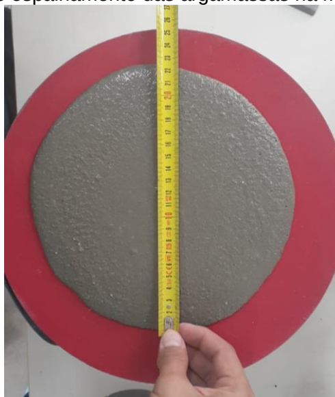
Figura 7 - Ensaio de espalhamento das argamassas na mesa de consistência.
