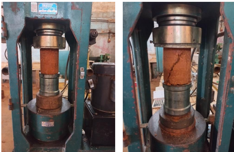
Figura 6: Ensaio de RCNC: a) Preparação do corpo-de-prova; e b) Corpo-de-prova após o ensaio
