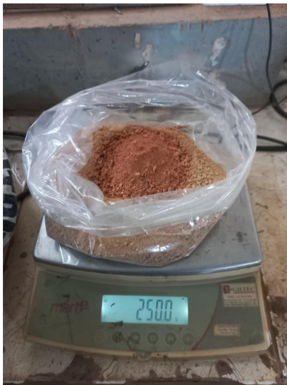
Figura 4: Procedimento de mistura solo + 10% de RCV
