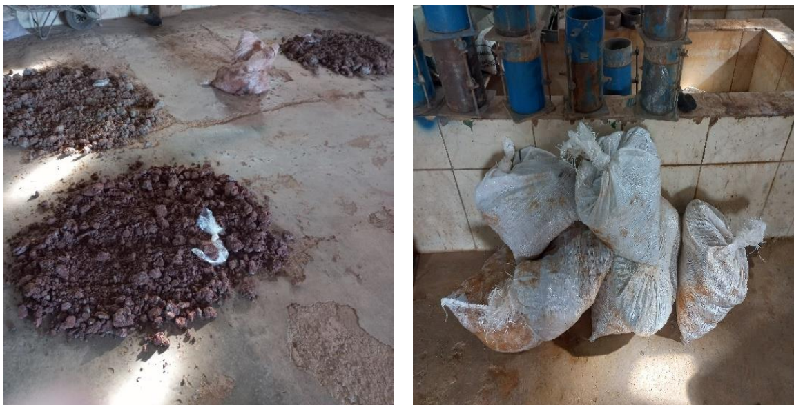
Figura 3: a) Secagem do solo ao ar livre, e b) Armazenamento dos solos em sacos plásticos
