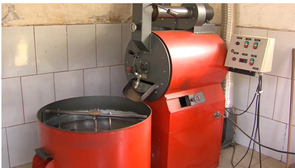
Figura 3 – Máquina fazendo o processo de torrefação do café.
