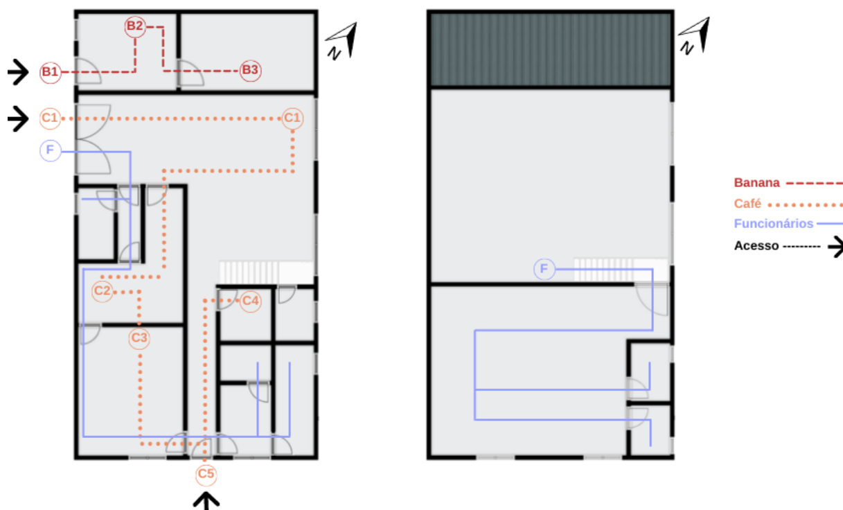
Figura 11 – Planta sinalizando a rota de produção da banana e do café, juntamente com a rota de funcionários.
