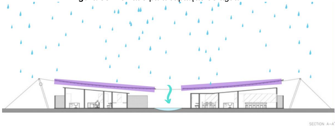
Figura 33: Telhado para captação de água
