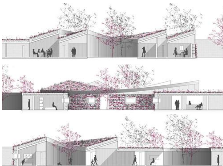
Figura 95 – Janelas, shed e telhado verde Fonte: Archdaily (2011)
