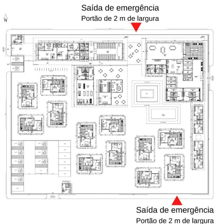
Figura 42 – Localização das saídas de emergência.
