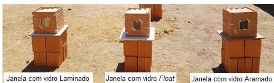
Figura 2: Apresentação das células-teste com os diferentes tipos de vidro
