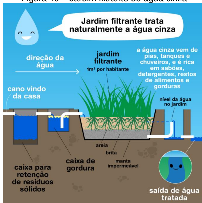
Figura 49 – Jardim filtrante de água cinza
