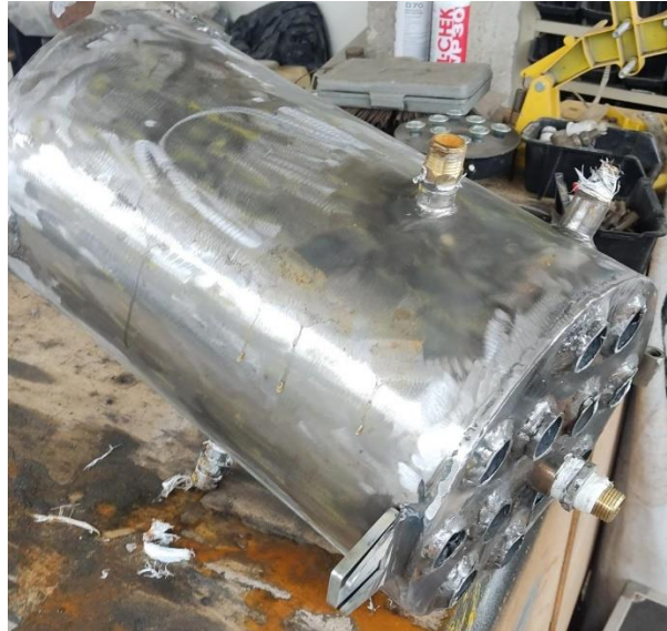
Figura 37 - Limpeza da parte estrutural do equipamento. Fonte: Acervo Pessoal, 2022
