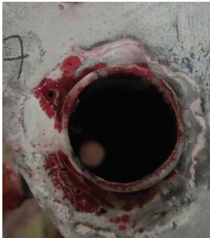
Figura 43 - Imperfeição no contorno da solda do tubo 07 no tampo superior. Fonte: Acervo Pessoal, 2022
