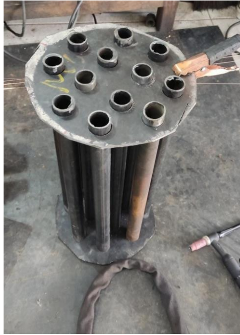
Figura 32 - Posicionamento dos tubos nos tampos. Fonte: Acervo Pessoal, 2022
