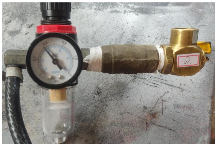
Figura 58 - Calibração da válvula de segurança 02. Fonte: Acervo Pessoal, 2022
