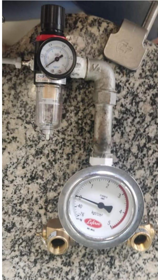
Figura 55 - Dispositivo para calibração. Fonte: Acervo Pessoal, 2022
