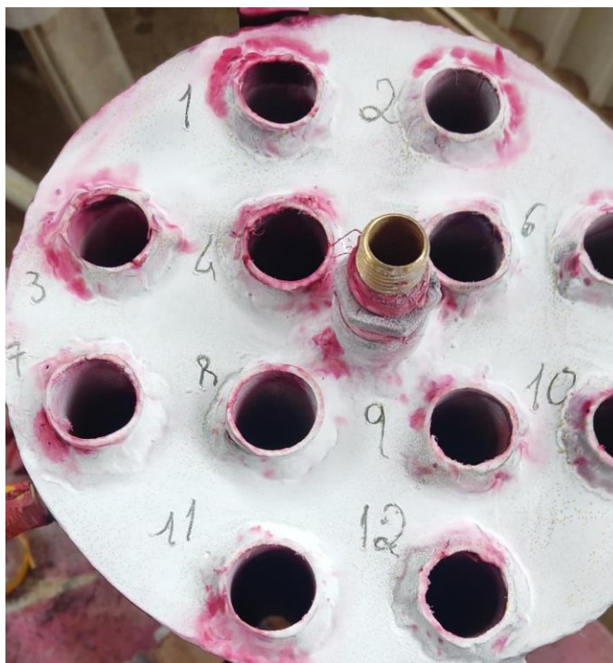
Figura 40 - Tampo superior após a aplicação do revelador. Fonte: Acervo Pessoal, 2022
