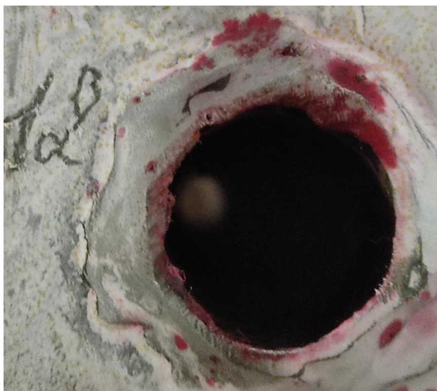
Figura 45 - Imperfeição no contorno da solda do tubo 12 no tampo superior Fonte: Acervo Pessoal, 2022
