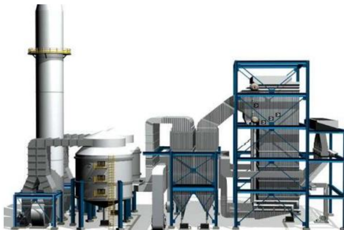
Figura 7 - Caldeira aquatubular compacta. Fonte: Brumazi (2013).
