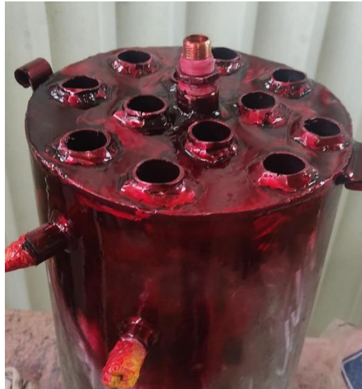
Figura 39 - Aplicação do Líquido Penetrante na parte superior Fonte: Acervo Pessoal, 2022
