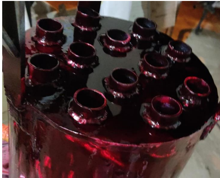
Figura 46 - Aplicação do Líquido Penetrante na parte inferior. Fonte: Acervo Pessoal, 2022
