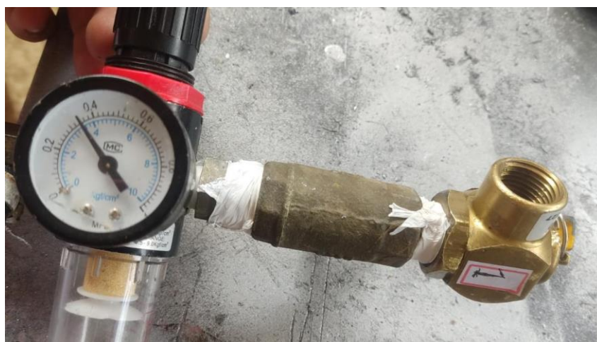
Figura 57 - Calibração da válvula de segurança 01. Fonte: Acervo Pessoal, 2022
