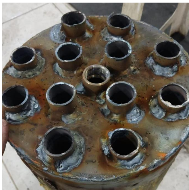
Figura 35 - Tampo superior após soldagem. Fonte: Acervo Pessoal, 2022
