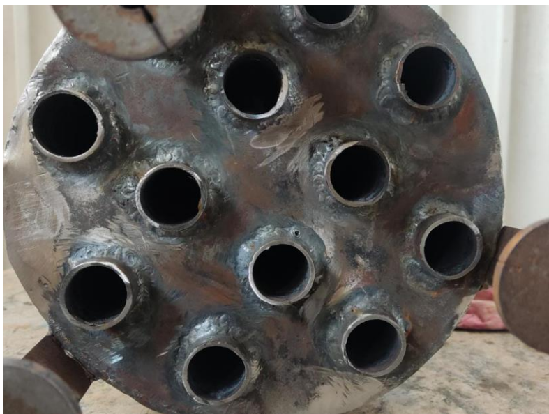
Figura 34 - Tampo inferior após soldagem. Fonte: Acervo Pessoal, 2022
