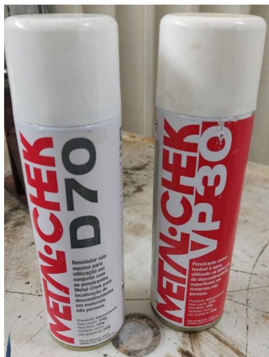
Figura 38 - Produtos para o ensaio de Líquido Penetrante Fonte: Acervo Pessoal, 2022
