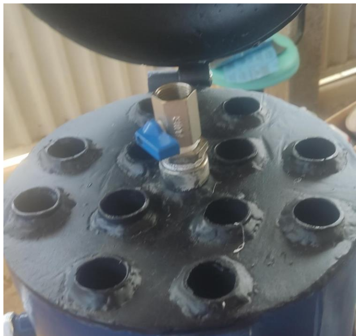
Figura 60 - Aplicação da camada de proteção no tampo superior Fonte: Acervo Pessoal, 2022
