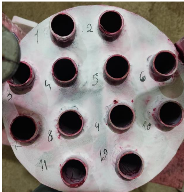
Figura 47 - Tampo inferior após a aplicação do revelador. Fonte: Acervo Pessoal, 2022
