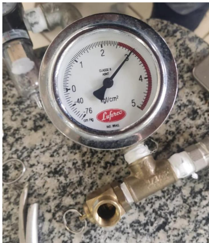
Figura 56 - Calibração do manômetro. Fonte: Acervo Pessoal, 2022
