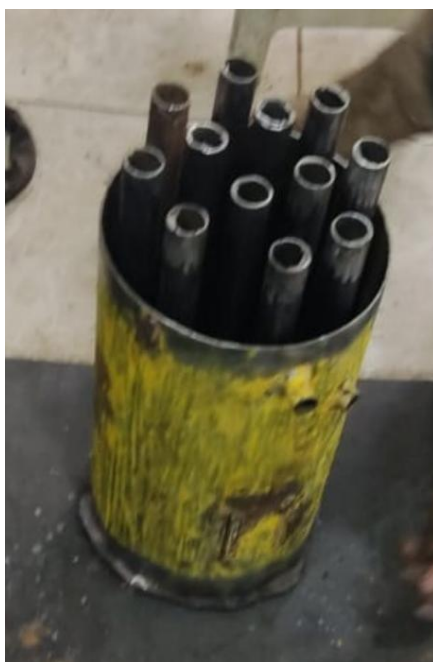
Figura 31 - Ajuste da altura dos tubos nos tampos. Fonte: Acervo Pessoal, 2022
