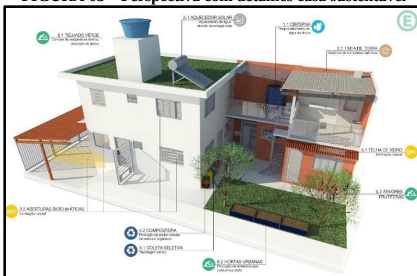
FIGURA 03 – Perspectiva com detalhes casa sustentável
