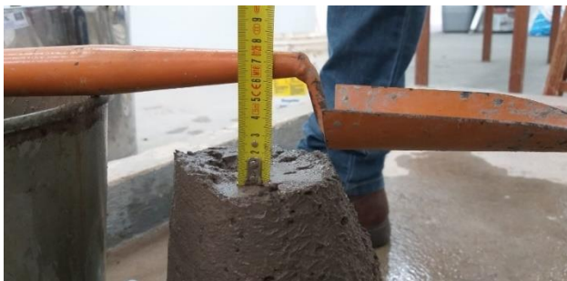
Figura 11 - Slump test realizado.
