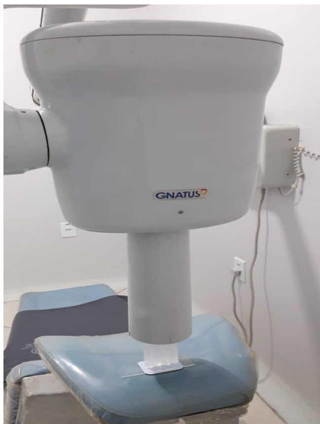
Figura 6- Mostrando o fantoma sendo radiografado.
