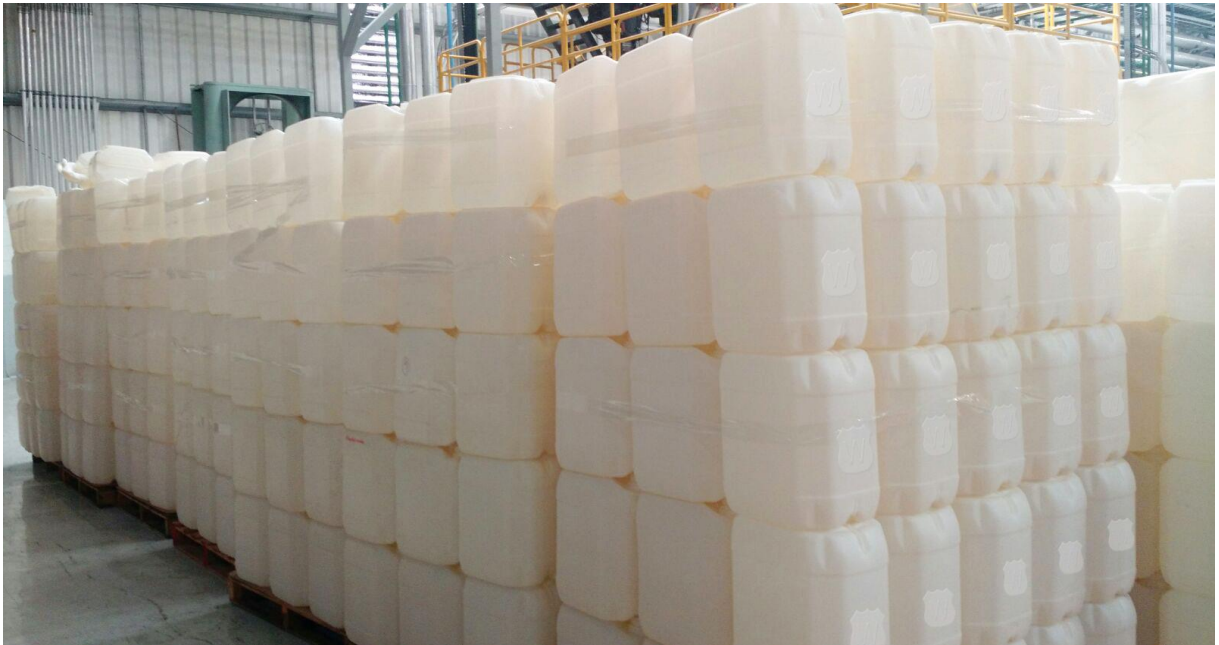
Figura 13 - Estoque de bombonas consequentes de fabricação incorreta
