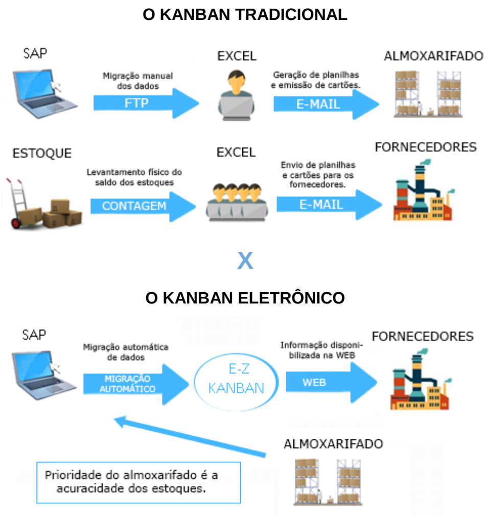
Figura 20 - Kanban tradicional versus Kanban Eletrônico da empresa estudada
