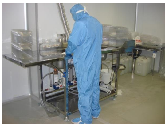
Figura 16: Adaptar bancadas nas pias de lavagem para apoio do Blister. de Blister. Fonte: Autor, 2015
