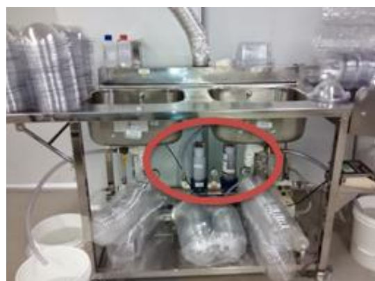
Figura 17: Adaptar filtros na pia de lavagem Fonte: Autor, 2015
