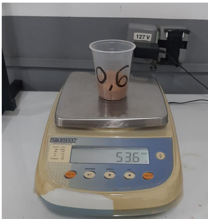
Figura 21 – Ensaio de Granulometria: Retido na peneira de 0,60 mm (1)
