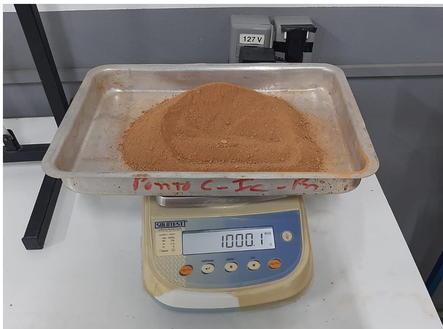
Figura 18 – Ensaio de Granulometria: amostra para peneiramento
