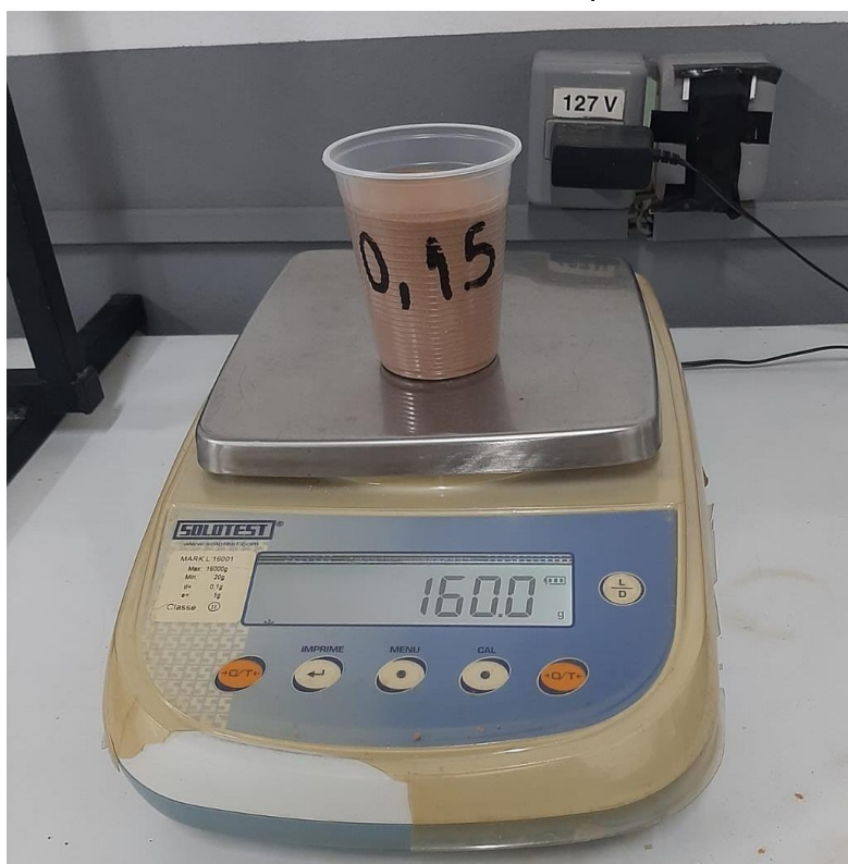
Figura 26 – Ensaio de Granulometria: Retido na peneira de 0,15 mm (1)
