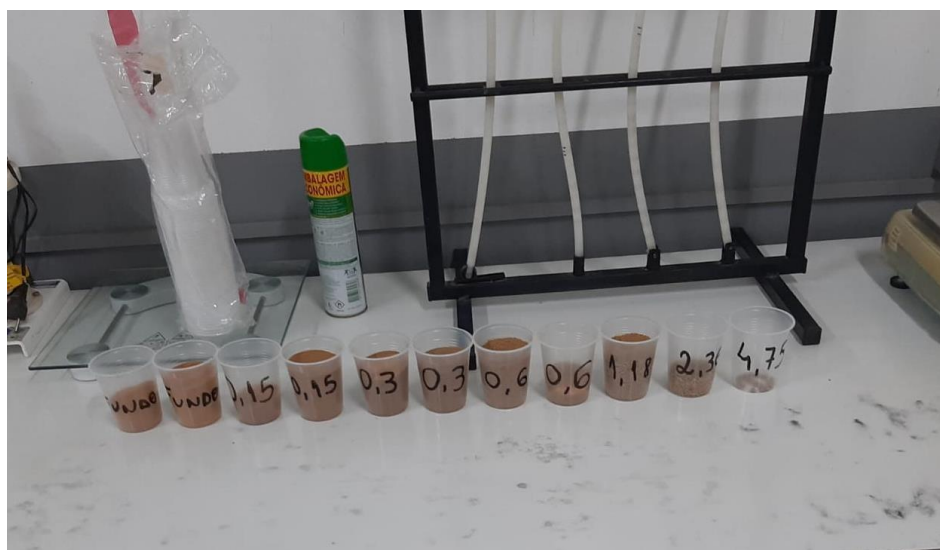
Figura 30 – Ensaio de Granulometria: Peneiramento completo
