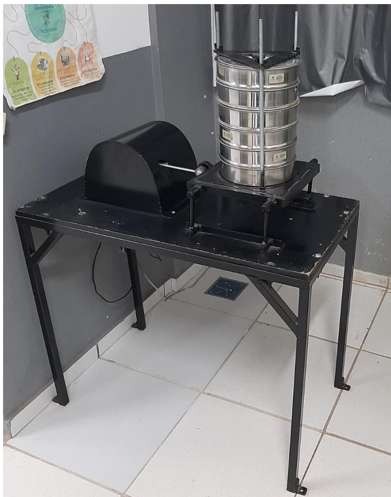
Figura 19 – Ensaio de Granulometria: Peneiramento
