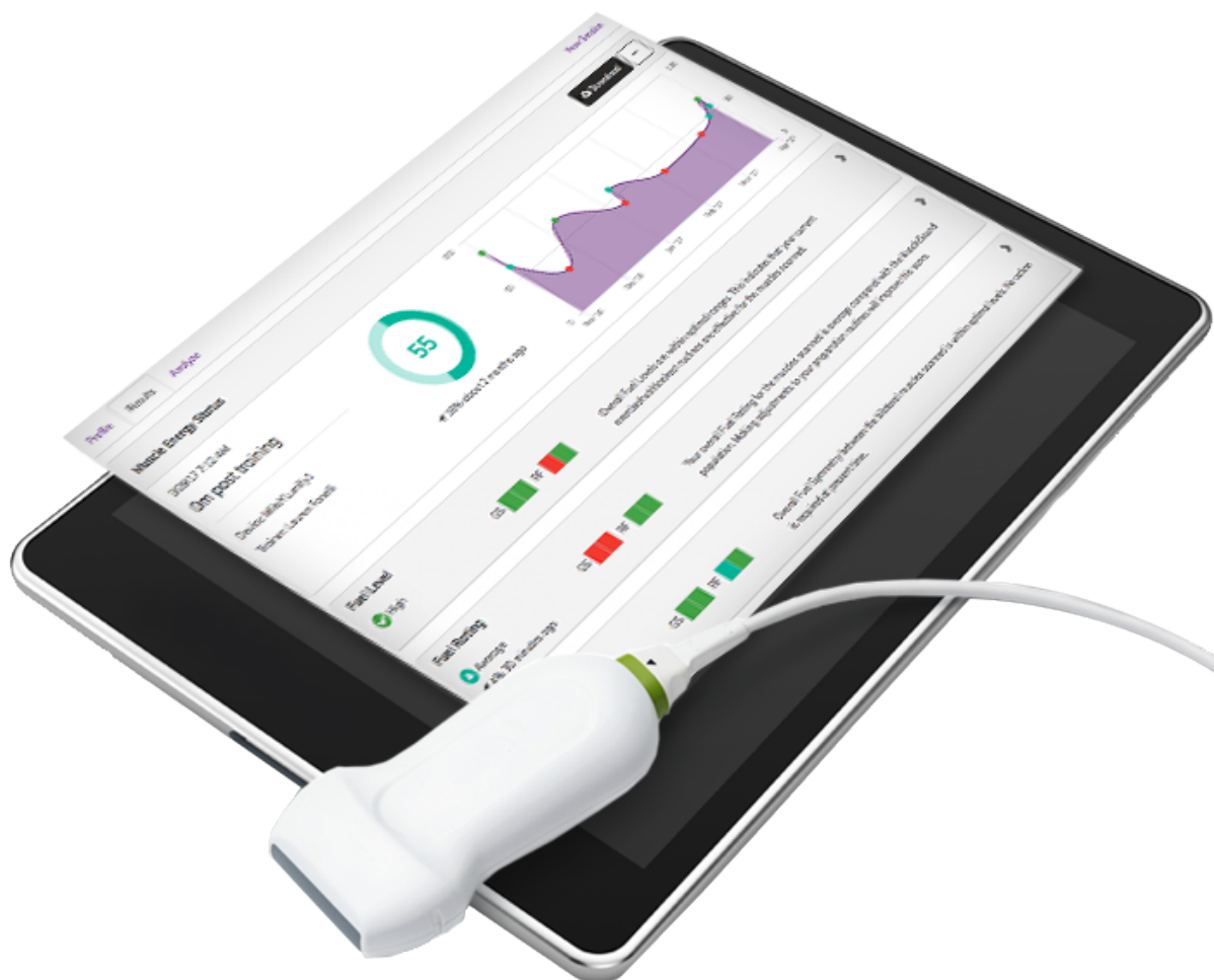
Figura 3 – O glicogênio muscular esquelético pode ser medido de forma rápida e não invasiva por meio de ultrassom de alta frequência utilizando a tecnologia MuscleSound.
