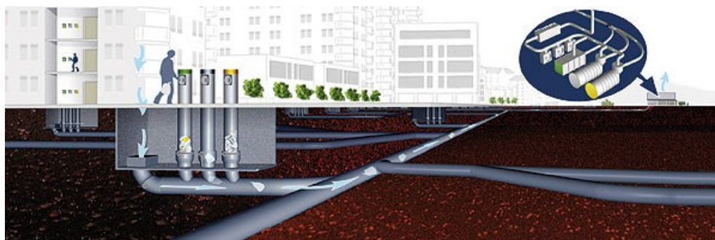
Figura 8: Estrutura de tubulação pneumática de resíduos
