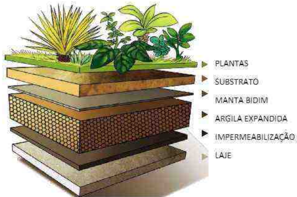
Figura 6: Camadas de um Telhado verde.
