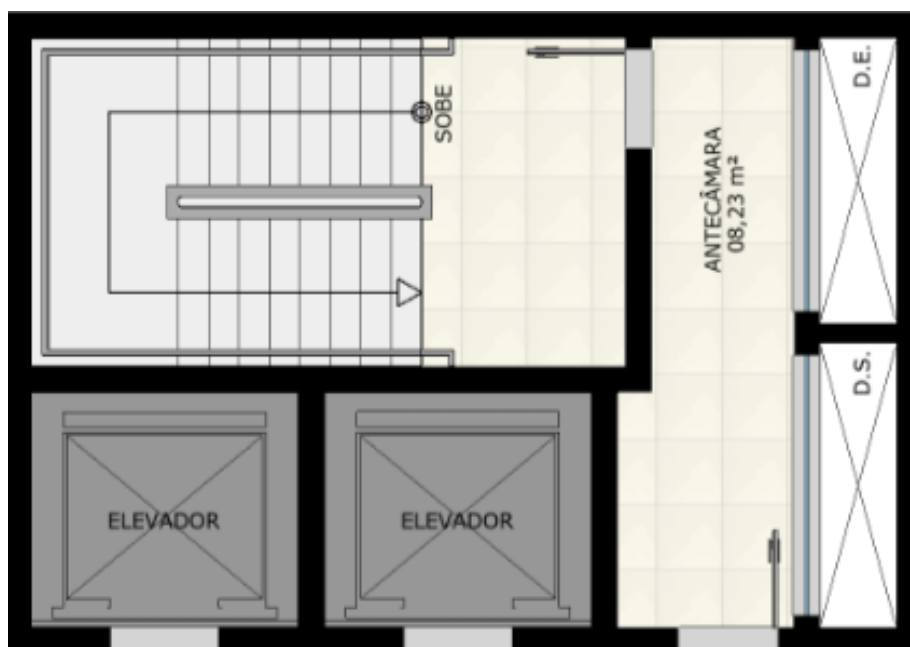
Figura 27 - Escada enclausurada à prova de fumaça.
