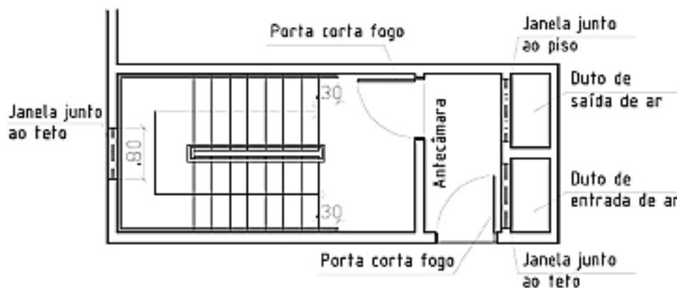
Figura 10: Escada Enclausurada a Prova de Fumaça.
