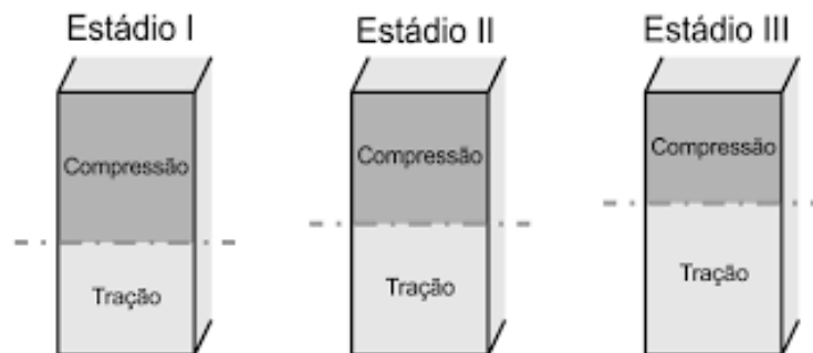
Figura 02: Estádios do concreto I,II e III.
