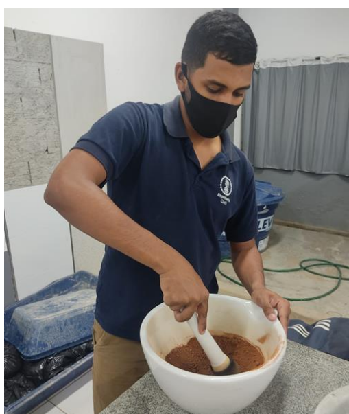
Figura 14: Preparação da amostra para peneiramento
