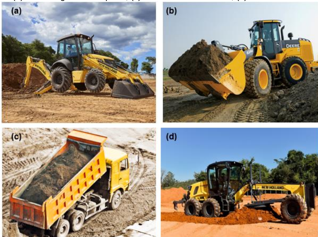
Figura 3 – Ilustrações de equipamentos utilizados em terraplanagem: (a) Retroescavadeira; (b) Pá carregadeira de pneu; (c) Caminhão basculante; (d) Motoniveladora
