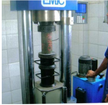
Figura 4 - Equipamento para o ensaio de compressão.
