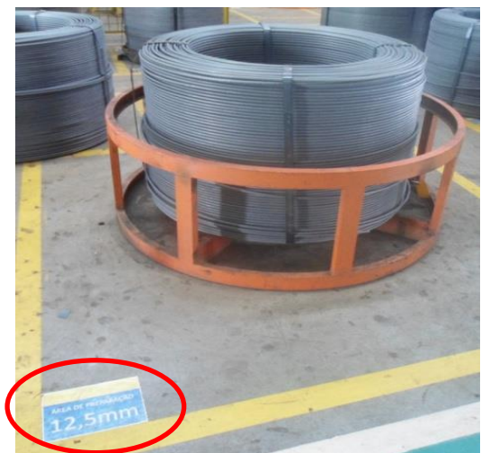
Figura 21 – Nova área de preparação para armazenagem dos rolos nas máquinas.
