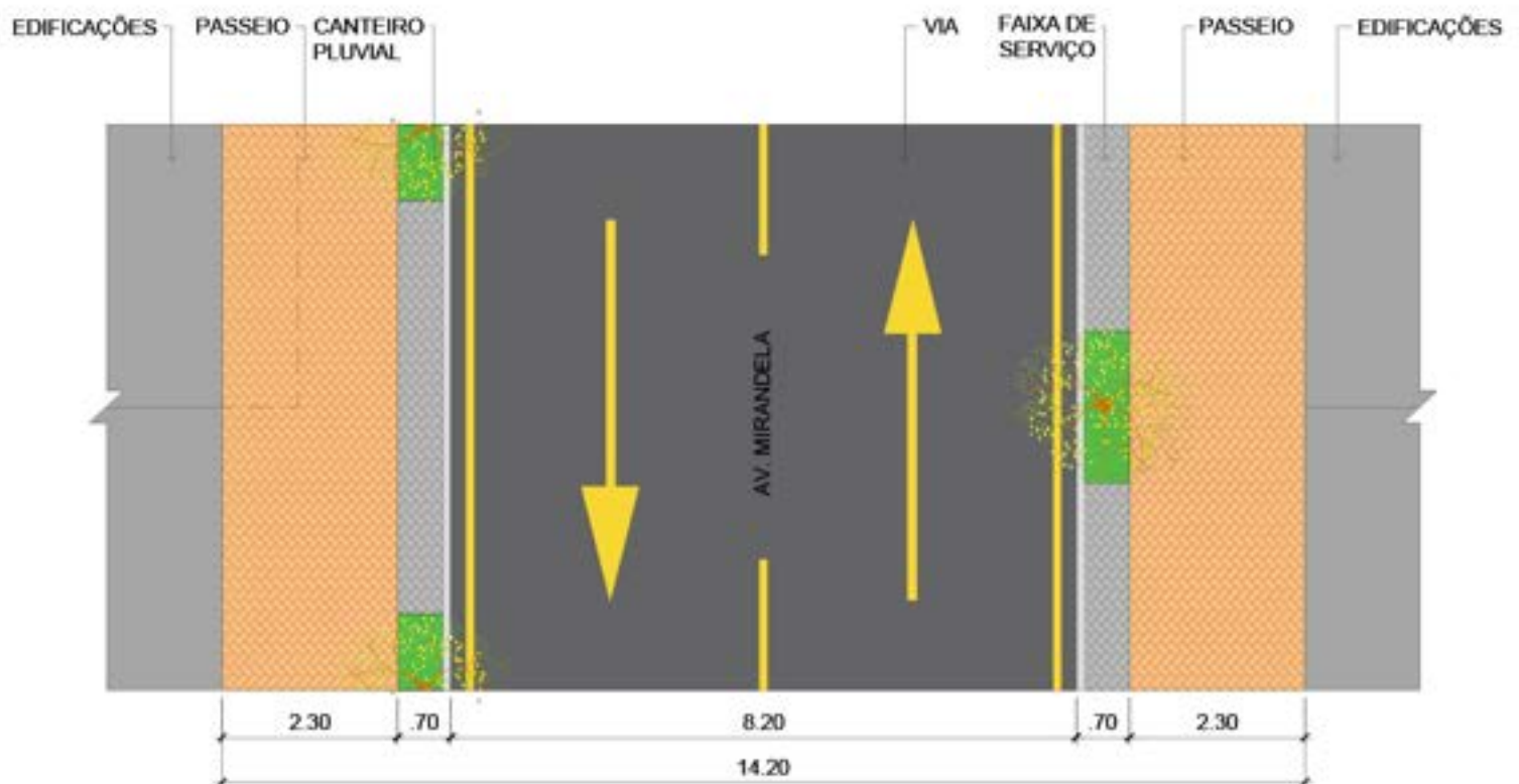
PLANTA BAIXA TECHO DA AV. MIRANDELA Esc.1:100
