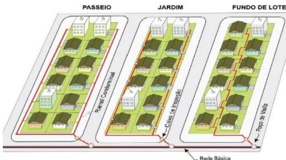
Figura 4- Esquemas possíveis de Ramais Condominiais Fonte: MELO, 2008
